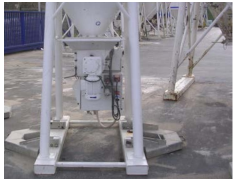
Abb. 4 Verbreiterung der Aufstandsflächen zur Erhöhung der Standsicherheit
