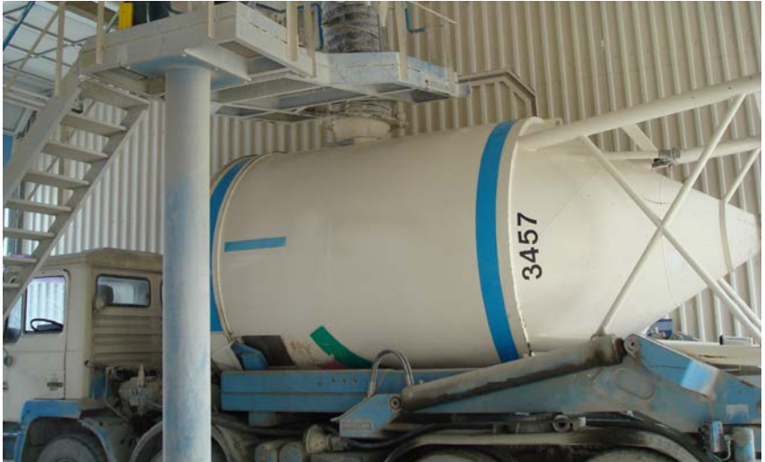
Abb. 1 Ortsfeste Beladestelle transportabler Silos
