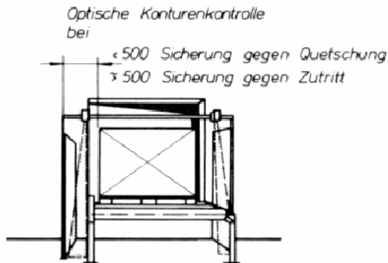
Bild 1: Optische Konturenkontrolle.
