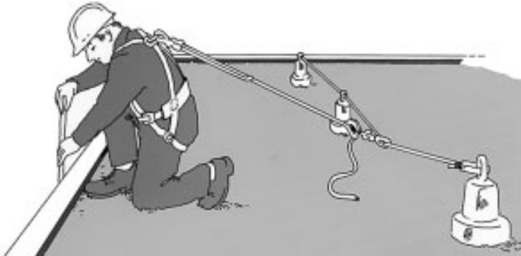
Bild 14: Anseilschutz bei Dacharbeiten
