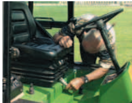
Für eine optimale Schwingungsdämpfung ist das Einstellen des Fahrergewichtes erforderlich.
