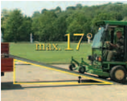
Verladeschienen dürfen einen Winkel von max. 17° nicht überschreiten.
