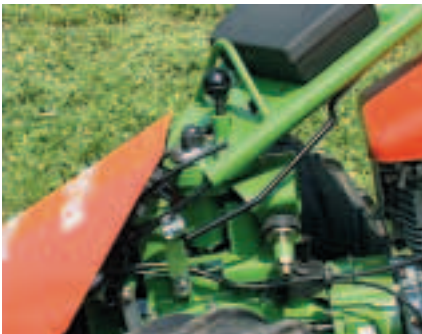
Antivibrationssysteme vermindern die Schwingungsübertragung auf die Bedienungsperson.
