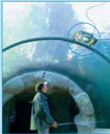
Tauchroboter für Reinigungsarbeiten im Aquarium – ein Absperren gefährlicher Tiere ist nicht erforderlich, und die Arbeitsbelastung wird verringert.
