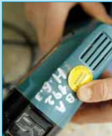
Eine Prüfplakette dokumentiert die durchgeführte Prüfung sowie den nächstfälligen Prüftermin.
