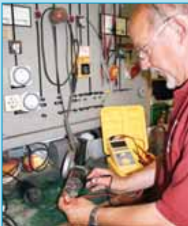
Prüfung eines ortsveränderlichen elektrischen Betriebsmittels durch eine Elektrofachkraft
