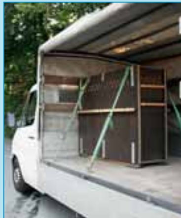
Ladungssicherung an einer Tiertransportkiste mit Antirutschmatte und Kantenschutz für die Zurrgurte
