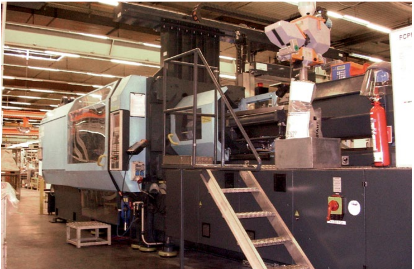
Abb. 1 Stationäre Messung an der Plastifiziereinheit (Bereich der Spritzdüse)
