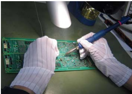
Abb. 2 Bleifreies Kolbenlöten mit Lötspitze, Lötendraht und Absaugung
