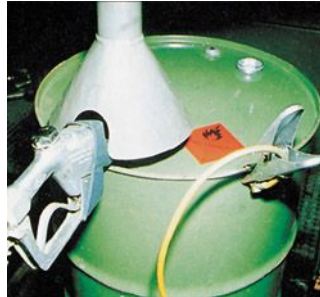
Abbildung 9: Absaugen an einer Fassabfüllung für gefährliche Flüssigkeiten
