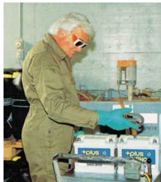
Abbildung 3: Befüllen von Batterien mit Schwefelsäure
