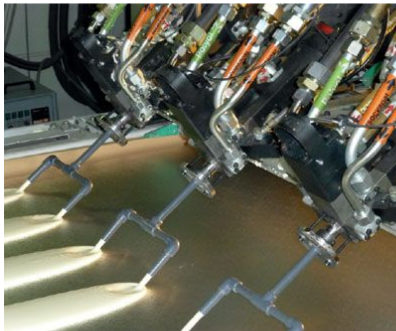
Abbildung 5: Moderne Mischköpfe mit integrierter Auftragseinheit
