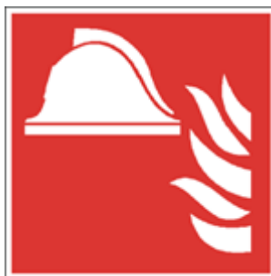
F004: Mittel und Geräte zur Brandbekämpfung
