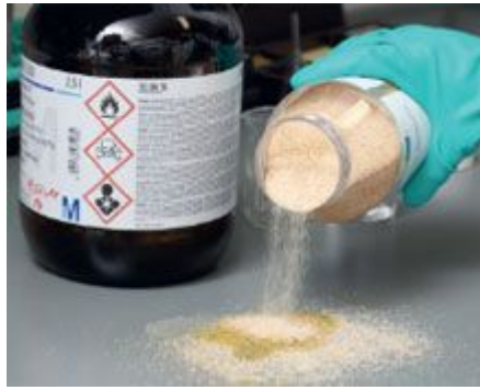
Abbildung 9: Lösemittel mit Absorptions-/Bindemittel aufnehmen
