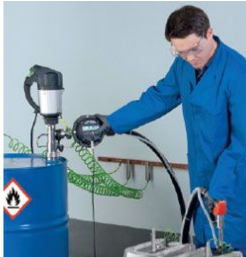
Abbildung 6: Umfüllen mit explosionsgeschützter Pumpe
