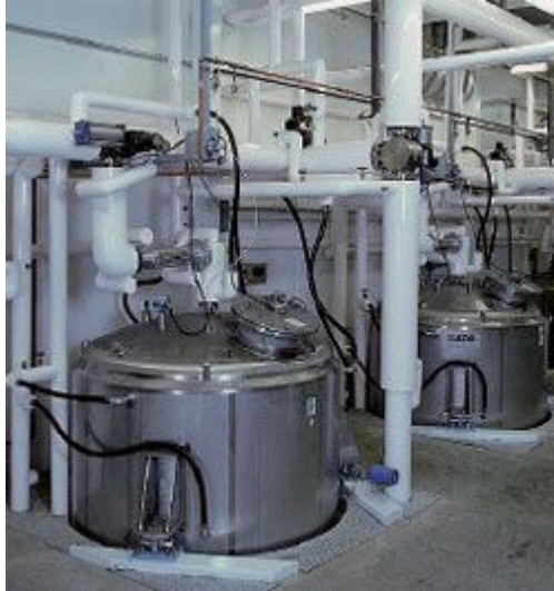
Abbildung 2: Flüssigkeitsvorlagenbehälter zur Verriegelung
