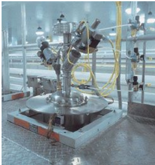
Abbildung 3: Flüssigkeitswiegesystem mit Entlüftung
