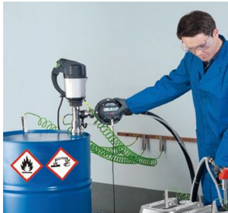
Abbildung 3: Umfüllen einer Säure
