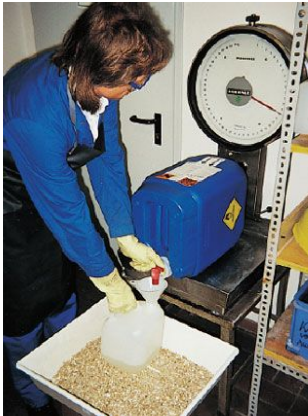
Abbildung 6: Umfüllen von flüssigem Organischen Peroxid unter Nutzung einer Auffangwanne mit inertem Absorptionsmittel
