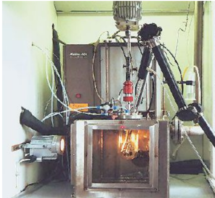
Abbildung 28: Reaktionskalorimeter mit IR-Spektrometer
