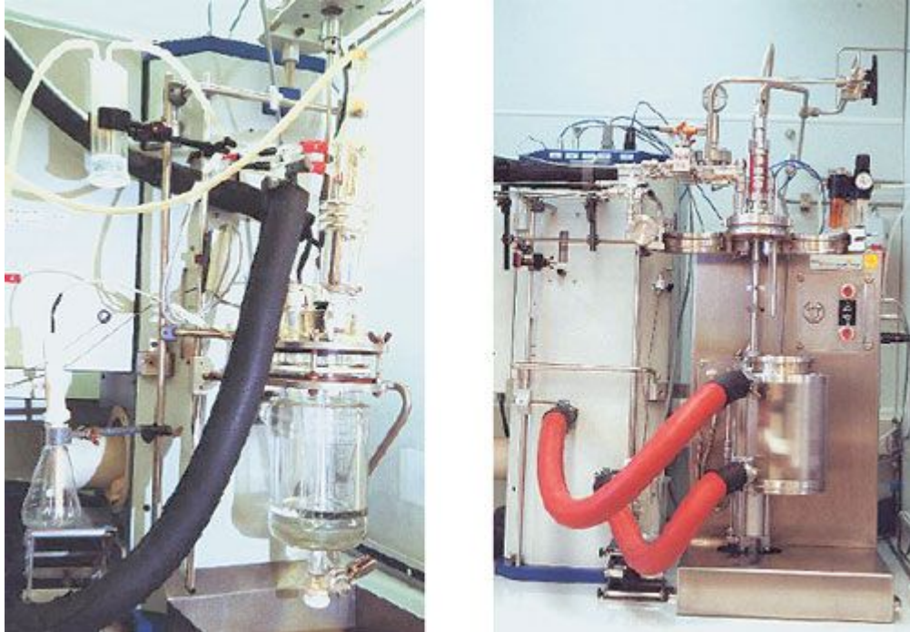
Abbildung 26: Reaktionskalorimeter aus Glas und Metall für verschiedene Druckstufen
