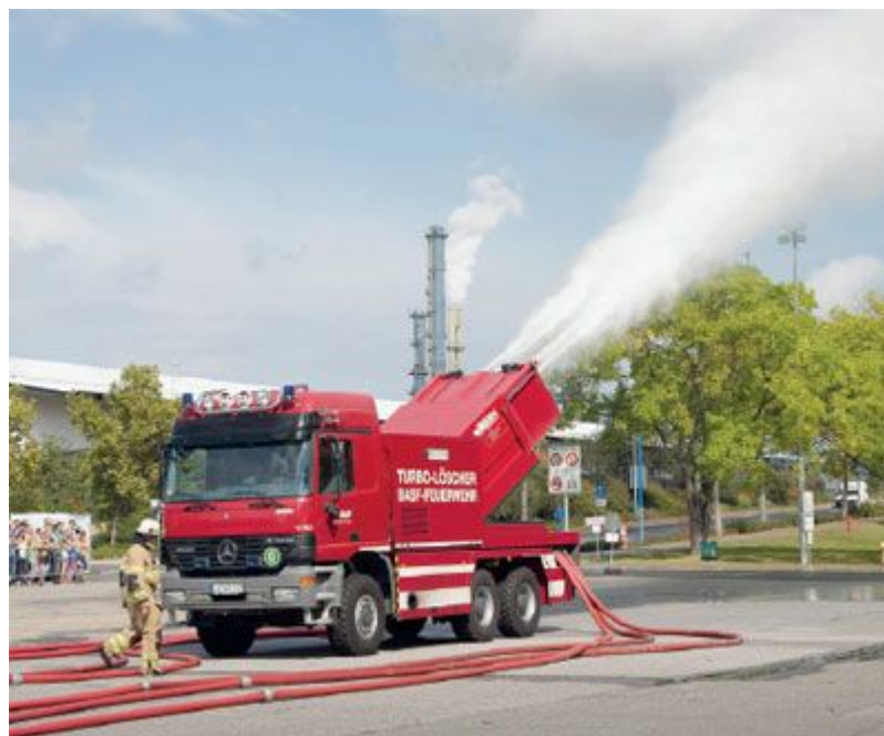
Abbildung 16: Wasserschleier der Feuerwehr dienen der Schadensbegrenzung nach einem Stoffaustritt
