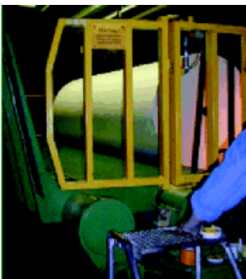
Bild 4 Die hochgestellte Absenkbühne verwehrt gemeinsam mit den seitlichen Türen den Zugang zu den Einzugstellen des laufenden Rollenschneiders.
