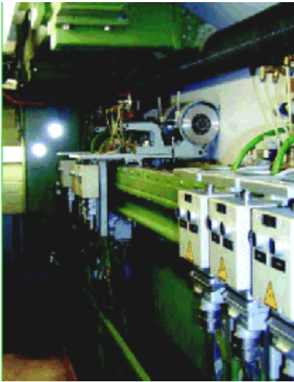
Bild 8 Zwei Lichtschranken sichern den Quetschbereich zwischen den einzelnen Messerstationen, die automatisch verfahren werden. Durch Unterbrechen der Lichtstrahlen wird nur die Positionierung gestoppt.
