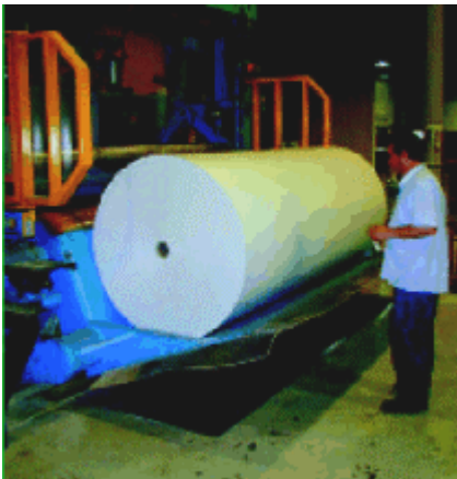
Bild 7 Eine Schaltmatte unter der Absenkbühne in Verbindung mit seitlichen Abweisern an der Bühne sichern gegen Quetschen beim Auswerfen der Rolle.
