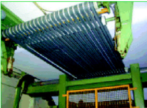
Bild 2 Eine Bänderführung führt die Bahn durch den Keller, ohne dass von Hand eingegriffen werden muss. Von Hand erreichbare Bandaufläufe sind durch eine Schutzstange gesichert.
