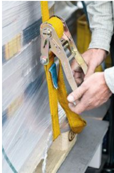
Abbildung 12: Sicherung der Ladung mit einem Zurrurt
