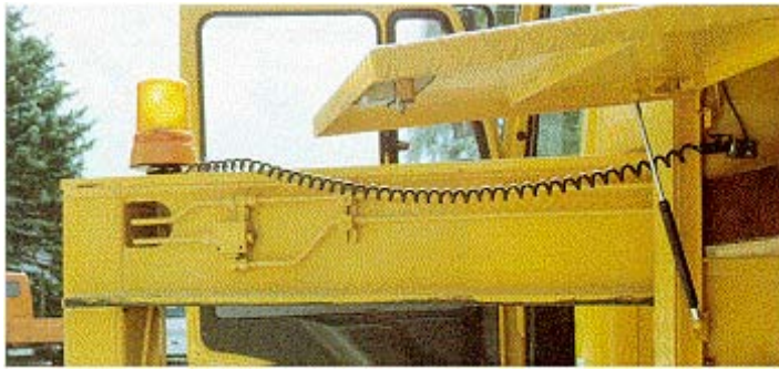
Abb. 16: Blinkleuchte mit Magnethalter auf dem Ausleger
