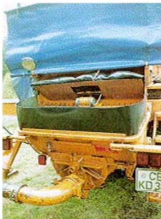
Abb. 25: Klappbare Trichterabdeckung und Schutzplane gegen Betonspritzer
