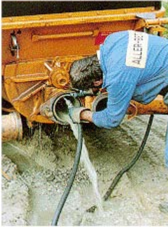
Abb. 38: Ausspritzen des Schiebergehäuses
