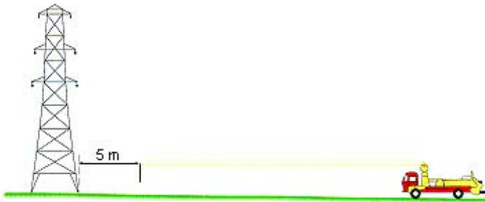
Abb. 8: Sicherheitsabstand zu Freileitungen
