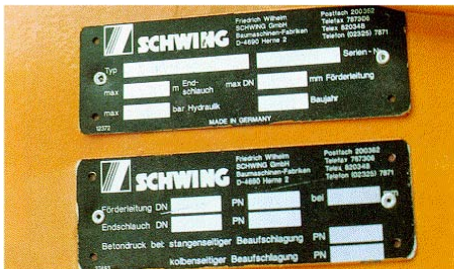
Abb. 31: Typenschild mit Endschlauchlänge
