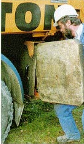
Abb. 43: Einschub und Sicherung der Abstützplatten
