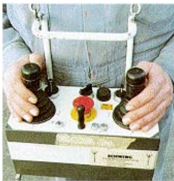
Abb. 22: Funkfernsteuerung mit Tragebügel und Tragegarnitur um den Hals
