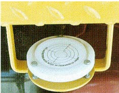
Abb. 14: Libelle zur Kontrolle der Neigung
