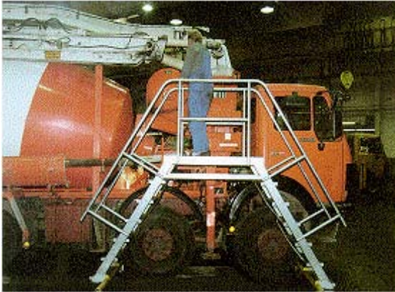
Abb. 45: Fahrbare Bühne für Wartung und Reparatur
