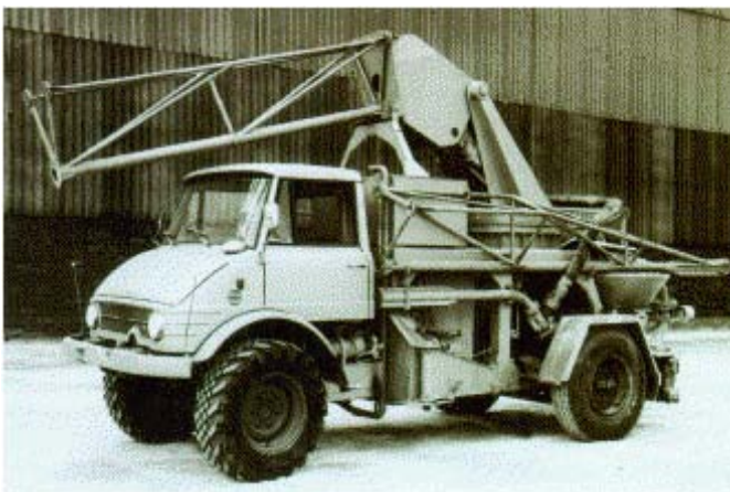
Abb. 1: Aus den Anfängen der Auto-Betonpumpen
