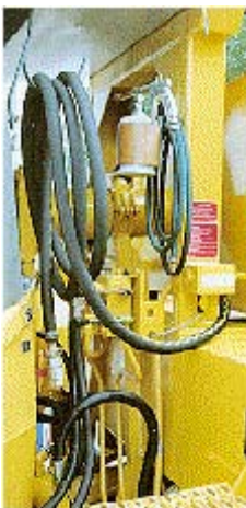
Abb. 41: Sicher auf dem Fahrzeug angebracht – Wasserschlauch und Sprühgerät mit Druckluftanschluß
