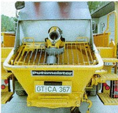
Abb. 39: Reinigungsöffnung in der Rohrweiche, Trittrost am Trichter
