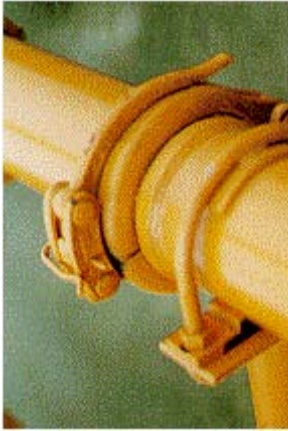
Abb. 18: Kupplung mit Federstecker
