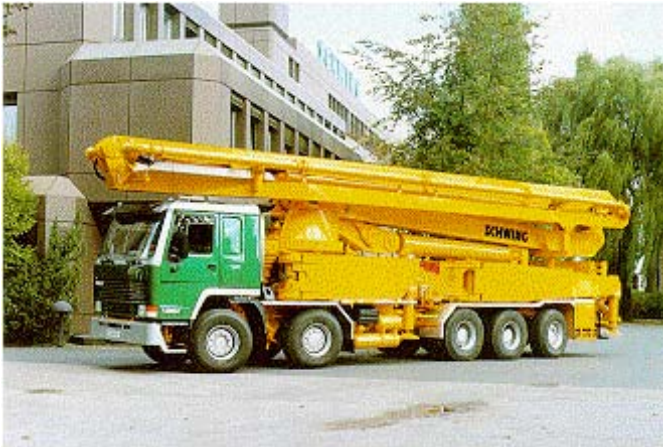
Abb. 2: Modernes Betonpumpenfahrzeug mit einer Reichweite von 52 m
