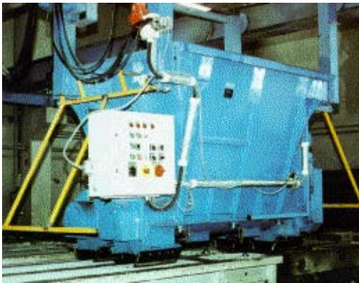
Abb. 7: Betonverteiler mit Abschaltbügel
