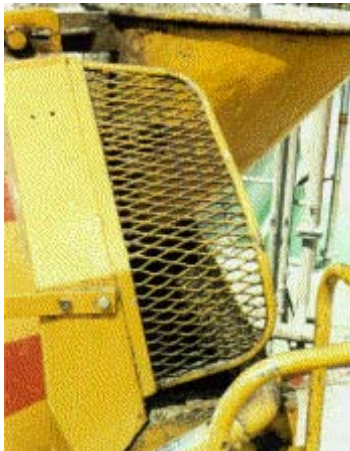
Abb. 23: Verdeckung der Quetsch- und Scherstellen am Aufgabetrichter
