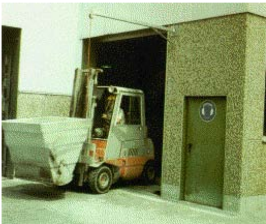
Abb. 1: Gabelstapler mit Betonkübel bei Tordurchfahrt
