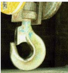
Abb. 6: Kranhaken mit Sicherungsklappe
