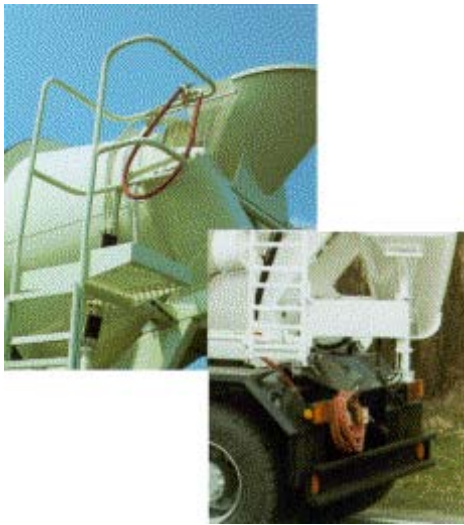
Abb. 22: Wasseranschlüsse am Fahrmischer
