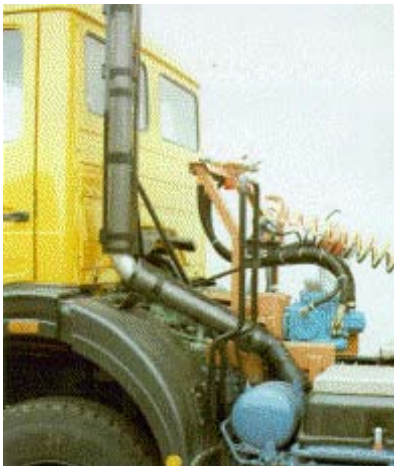
Abb. 27: Schutz gegen Berühren des Auspuffrohres
