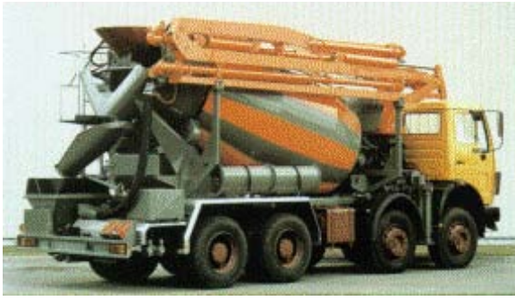
Abb. 30: Fahrmischer mit Betonpumpe
