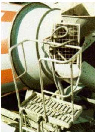
Abb. 20: Arbeitspodest am Fülltrichter
