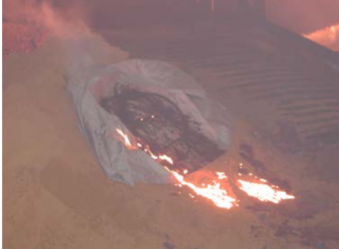
Abb. 8 Jacke nach Übergussversuch
