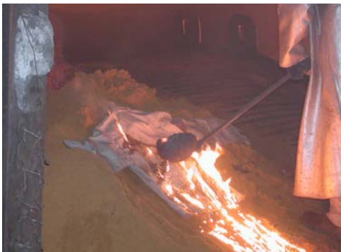
Abb. 7 Jacke mit Schmelze übergießen
