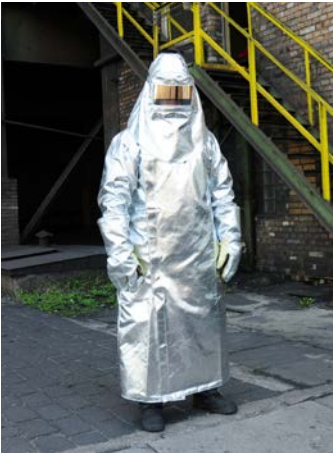
Abb. 1 aluminisierter Hitzeschutzmantel, hier kombiniert mit Hand- und Kopfschutz
