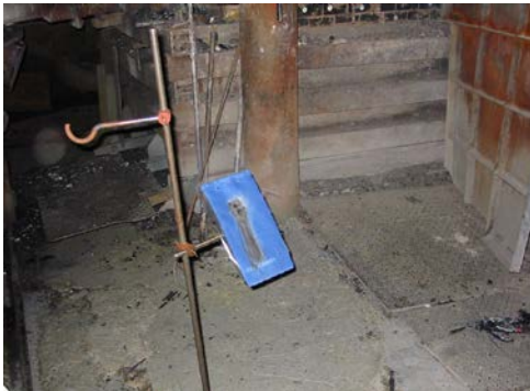
Abb. 9 Verwendung eines selbstgefertigten Prüfgestelles zum Testen einer Materialprobe
