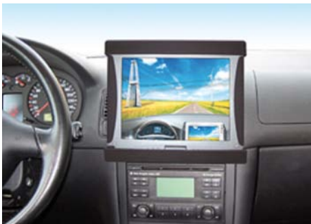
Abb. 10 Tabletintegration Kfz durch Einhausung (© Fa. Tormaxx, mit freundlicher Genehmigung)
