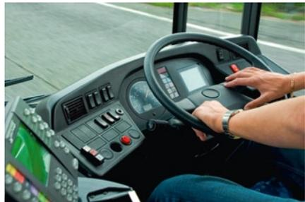
Abb.7. seitlich positionierter Bildschirm
