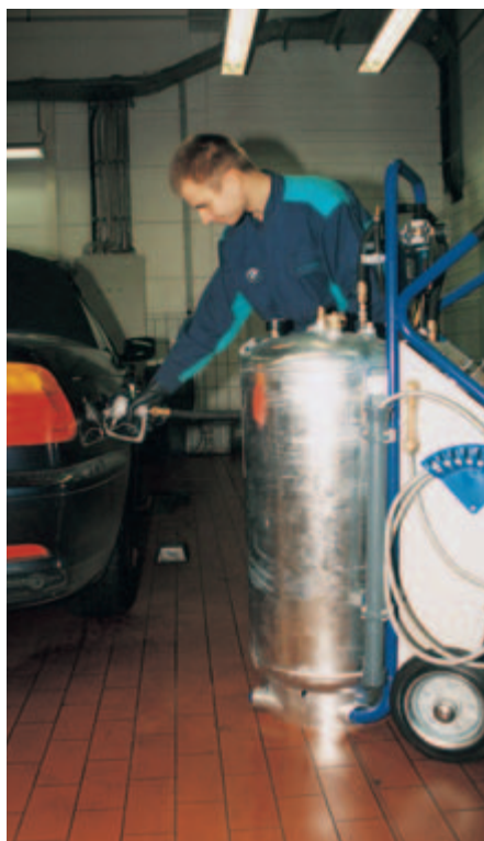
Bild 5-4: Entleerung des Systems mit der Anlage Mobilus 100
