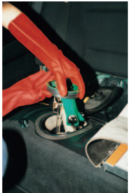
Bild 5-6: Ausbau eines Tankgebers
