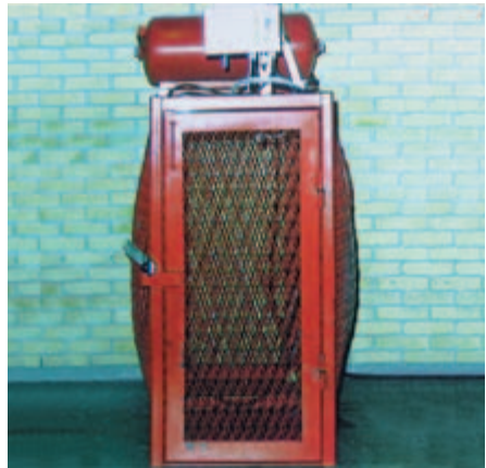
Bild 5-16: Deformation eines Lkw-Befüllkäfigs nach dem Platzen eines Reifens
