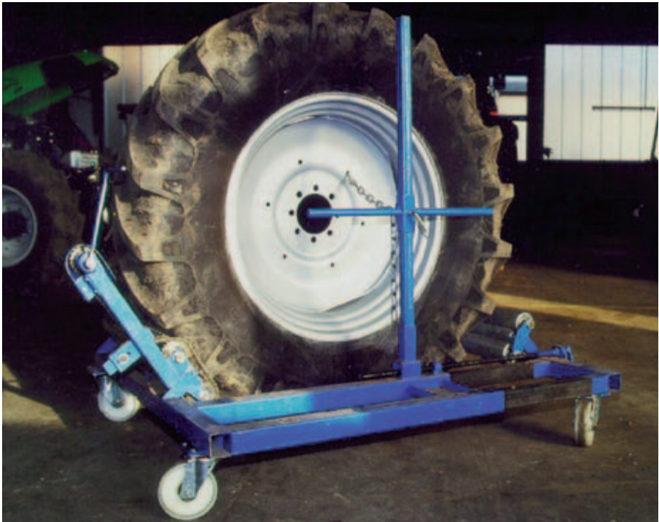
Bild 5-19: Einsatz eines Radwechselwagens
