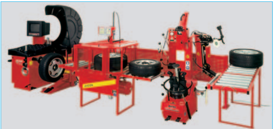
Bild 5-15: Montagestraße mit integrierter automatischer Befülleinrichtung
