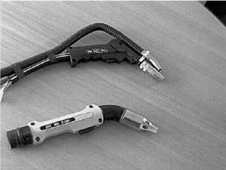
Bild 4-2: Erfassungselement am Brenner befestigt und Brenner mit integrierter Absaugung
