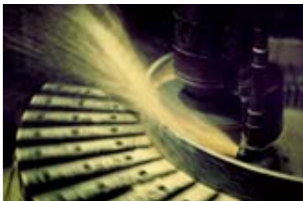
Bild 5-2: Schleifen von Wälzlageringern
