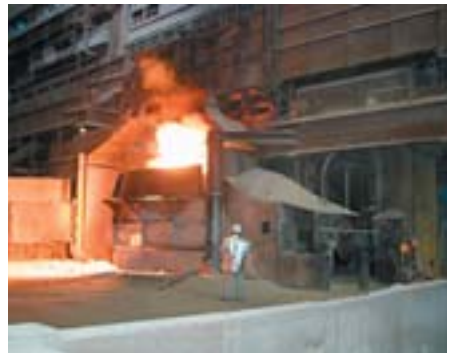
Bild 5-6: LD-Konverter während des Frischprozesses
