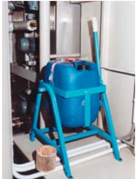
Bild 1-4: Ballonkipper zum Umfüllen
