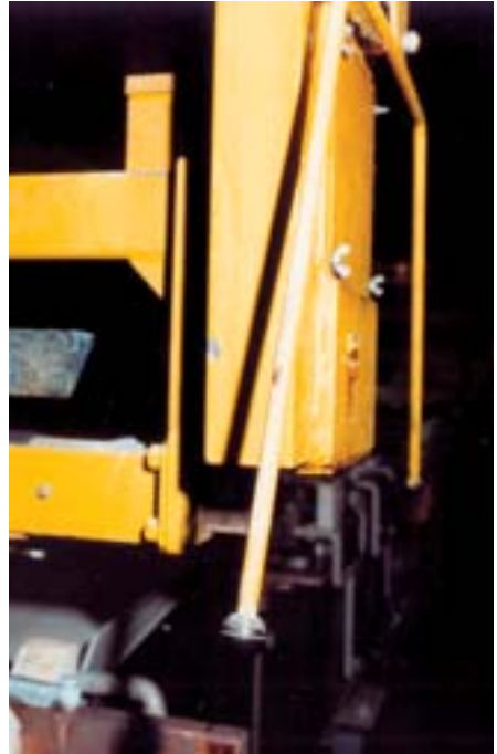
Bild 3-7: Anfahrbügel am Transportwagen. Eine Abdeckplatte wäre ein besserer Schutz
