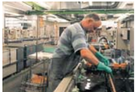
Bild 2-1: Handbeschickung an einem Silberbad
