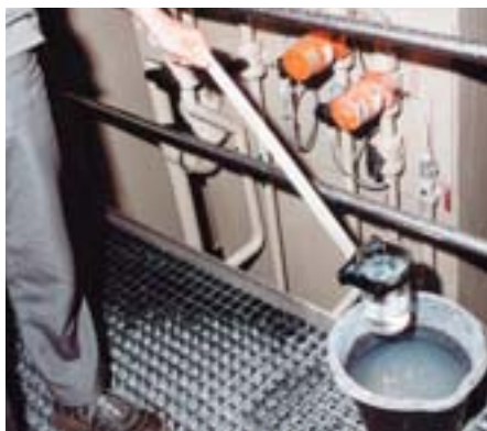
Bild 1-1: Vom Betrieb selbst hergestelltes Probenahmegerät
