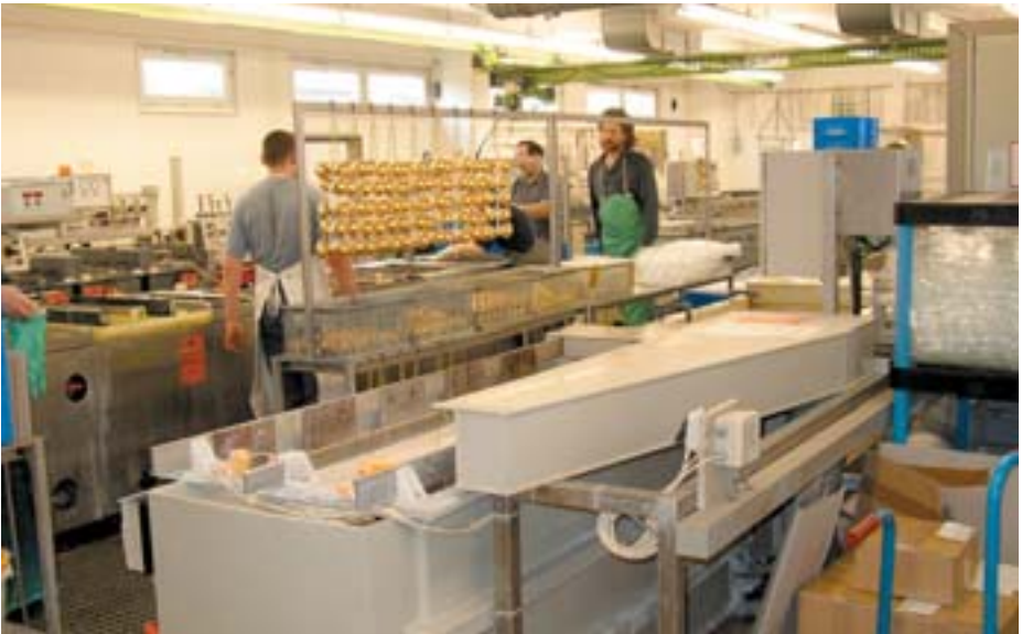
Bild 1: Eine moderne Handgalvanik
