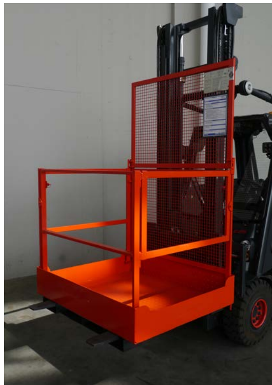
Abb. 3 Arbeitsbühne am Gabelstapler
