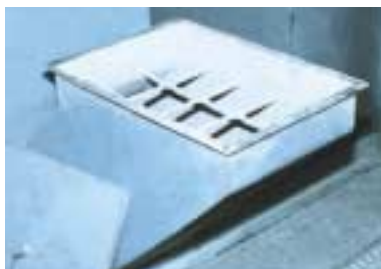
Abb. 38: Einwurftrichter mit Rostabdeckung
