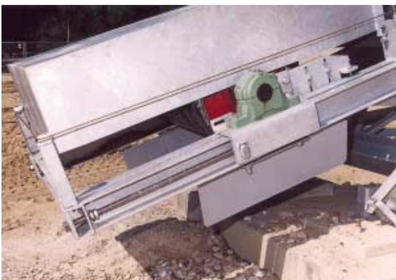
Abb. 7: Verdeckung der Spanntrommel mit Verstellmöglichkeit von außen
