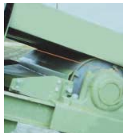
Abb. 9: Pflugabstreifer – zur Sicherheit und Reinigung
