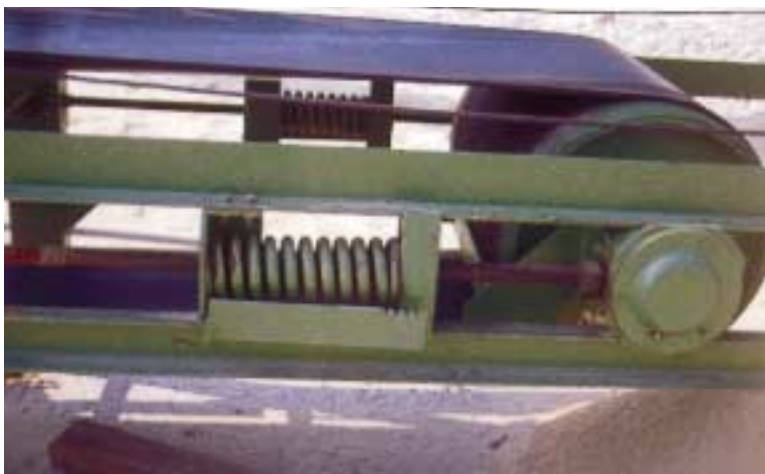
Abb. 8: Winkel als Füllstück an der Spanntrommel
