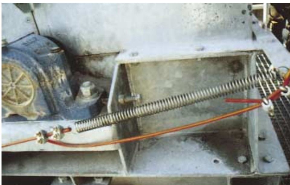
Abb. 19: Richtige Installation von Reißleinen
