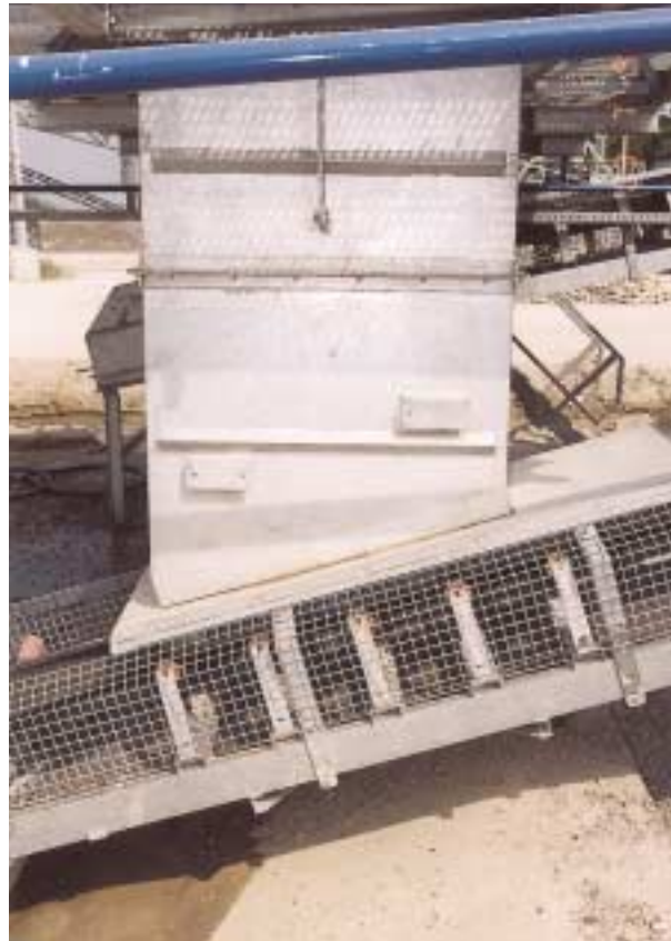
Abb. 12: Schutzgitter an Tragrollen
