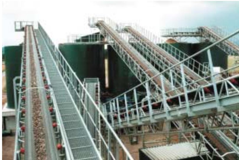
Abb. 22: Laufstege und Bühnen am Bandkopf
