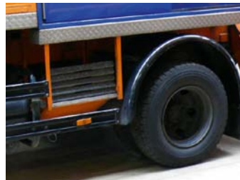
Bild 3 und 4: Lkw-Stütze mit Unterlegplatte und Aufnahmevorrichtung am Lkw
