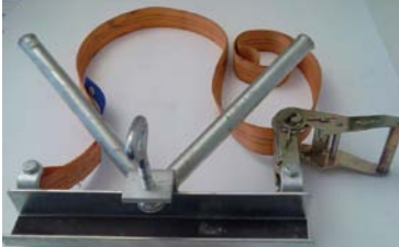
Bild 22: Abrutschsicherung für den Einsatz von Anlegeleitern an Holzmasten
