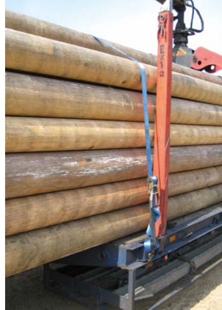
Bild 6: Beispiel für den Einsatz von Zurrgurten auf einem Transportfahrzeug
