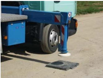
Bild 3 und 4: Lkw-Stütze mit Unterlegplatte und Aufnahmevorrichtung am Lkw
