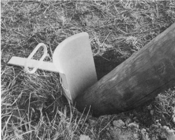
Bild 11: Mastabgleiter zum Stellen von Holzmasten in Mastlöchern
