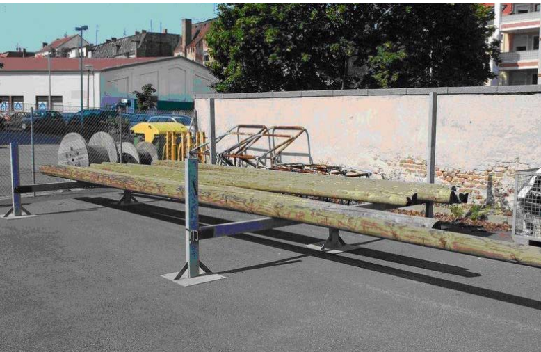
Bild 1: Zum Schutz vor Bodenfeuchtigkeit hat sich z. B. eine Lagerung von Masten auf Gestellen bewährt.
