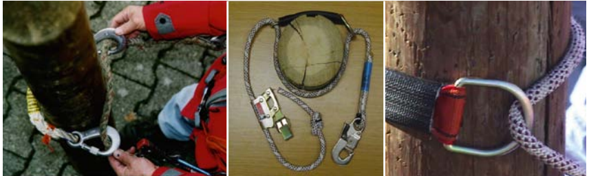
Bild 20: Das Klemmseil gewährleistet eine sichere Fixierung des Verbindungsmittels am Holzmast. Abrutschende Personen werden sicher gehalten.
