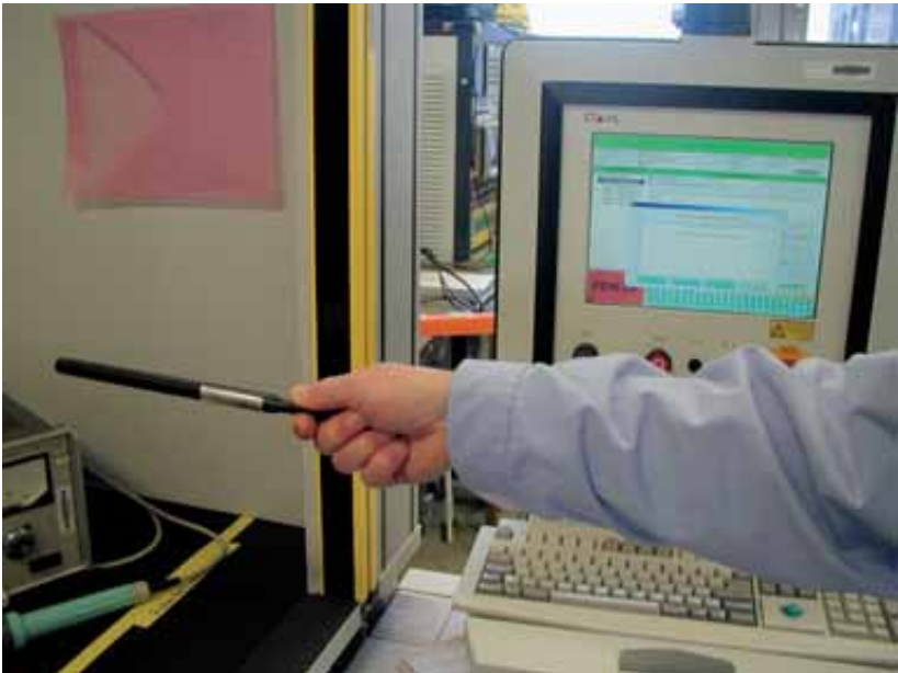
Bild 2 Funktionskontrolle der Sicherheitslichtschranke mittels Prüfstab
