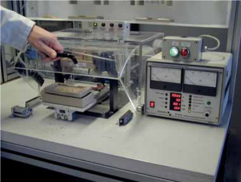
Bild 3 Prüfplatz mit zwangsläufigem Berührungsschutz, vollständiger Berührungsschutz durch Gehäuse mit beweglicher Verdeckung, elektro-mechanische Verriegelung mit Stellungsüberwachung (hier: Endschalter mit Personenschutzfunktion)
