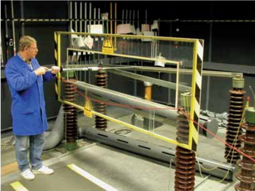
Bild 8 Prüffeld, Wiederholungsprüfung an einem Spannungsprüfer, Abrolltest. Abgrenzung durch Seil und Polykarbonatscheibe, Absaugung (Ozon!)
