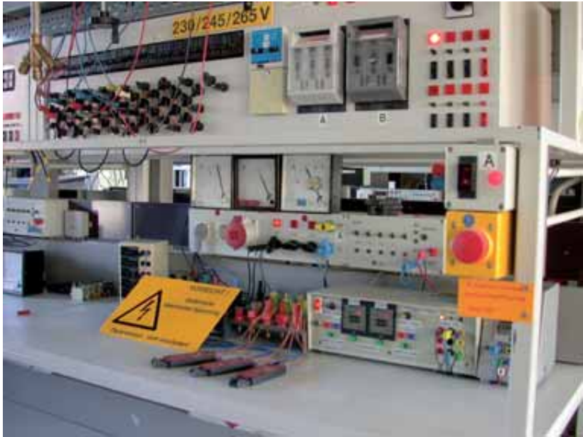
Bild 10 Dauerversuch in abgeschlossenem Raum, das Prüfredal liegt seitlich zum Hauptverkehrsweg. Berührungsschutz ist ausreichend, zufälliges oder unbeabsichtigtes Berühren ist durch Anordnung und Wahl der Anschlussmittel verhindert.
