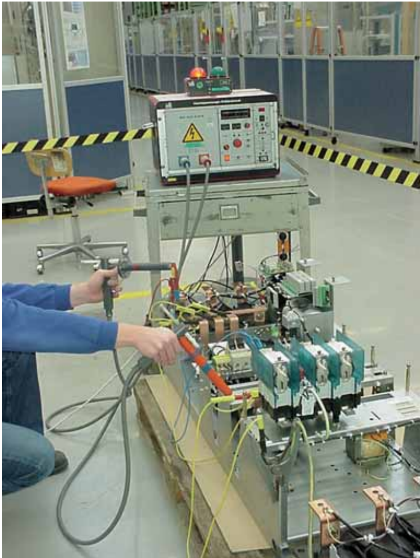
Bild 6 Prüfarbeiten unter Verwendung von Sicherheitsprüfspitzen
