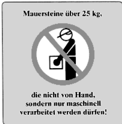
Bild 16: Hinweis- und Verbotssymbol für Mauersteine über 25 kg Verarbeitungsgewicht
